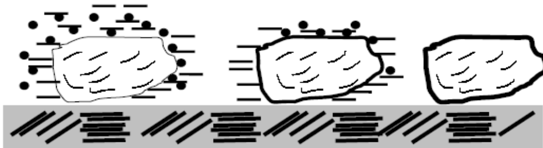
Figura 6. Ruptura de una Emulsión Asfáltica sobre un Material Pétreo
