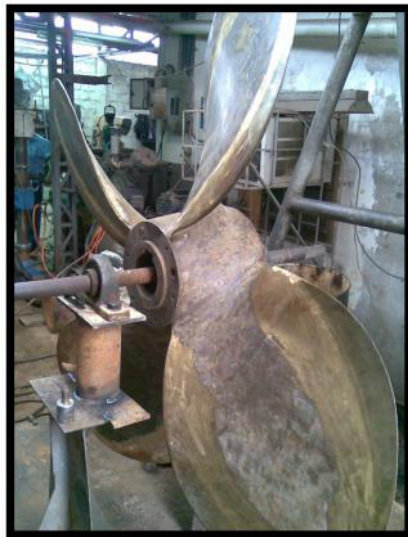
Figura N° 46. Balanceo estático de las hélices.
