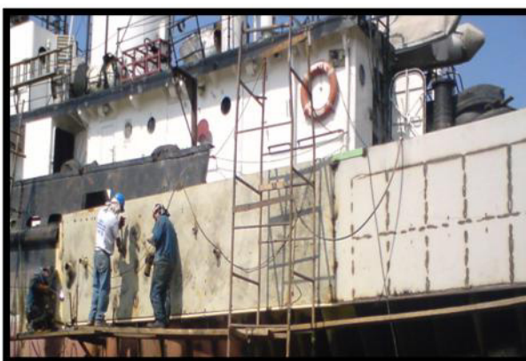
Figura N° 9. Montaje del planchaje de costado.
