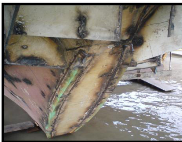
Figura N° 3. Corte y sellado del codaste central.
