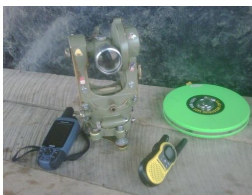
FIGURA 3.2: EQUIPO PARA REPLANTEO EN EL TERRENO.
