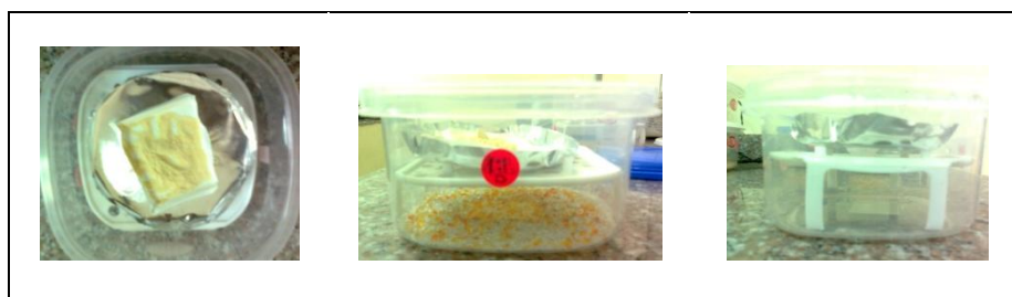
FIGURA 2.4. SISTEMA DE ISOTERMAS: VISTA SUPERIOR, SISTEMA CON SILICA GEL, SISTEMA CON AGUA.
