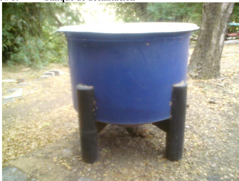
Figura # 5. Tanque de decantación
