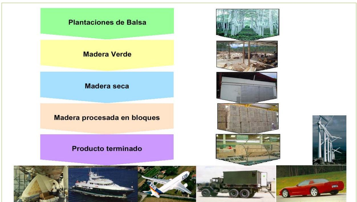
**Figura IX.** Proceso de Producción
