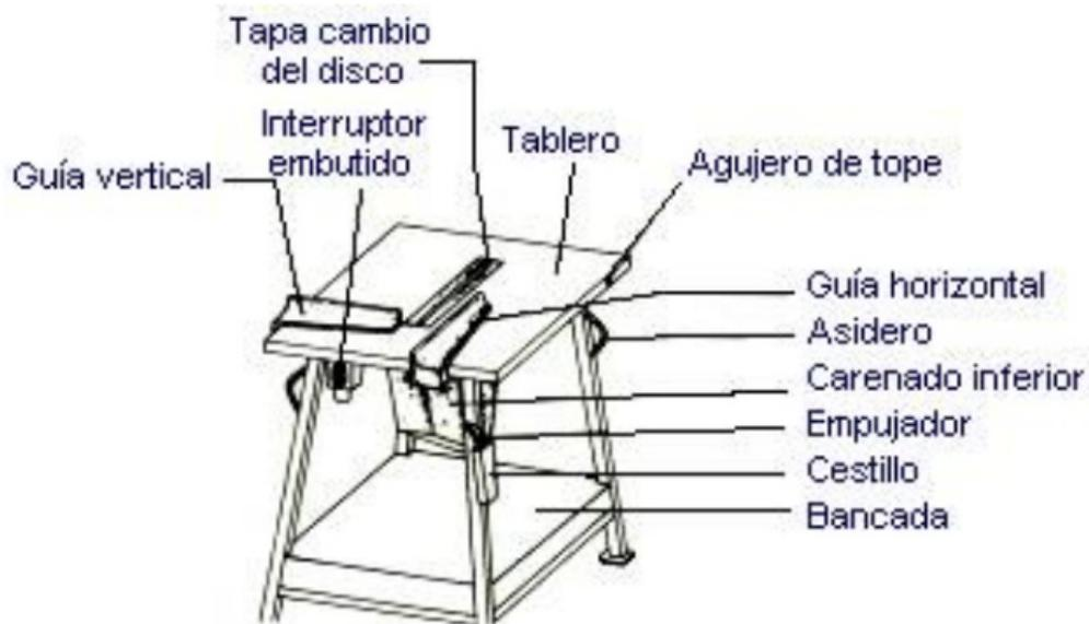
La sierra circular utilizada comúnmente en la construcción es una máquina ligera y sencilla, compuesta de una mesa fija con una ranura en el tablero que permite el paso del disco de sierra, un motor y un eje porta-herramienta.
