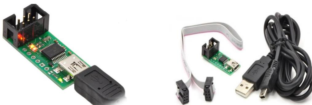
**Fig. 2.3 Programador AVR USB**
