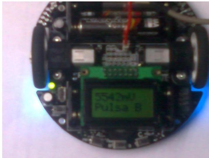
**Fig. 4.3.1 Pololu 3pi visualización de voltaje**
