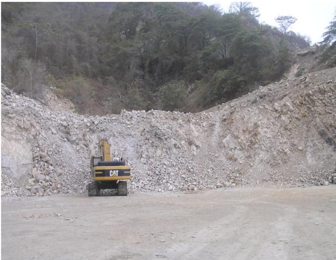
**FIGURA 2.3.-** Foto de extracción de material ya volado.
