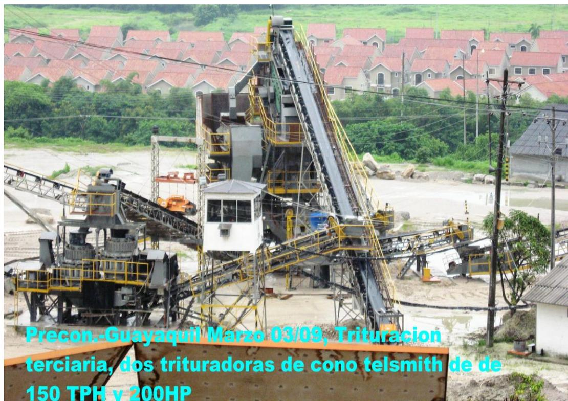
**FIGURA 2.8.-** Foto de equipos de trituración y separación de sección terciaria
