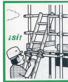
Fig.1. 13 Escaleras de acceso a andamios
