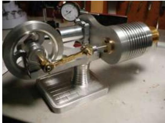
**Figura N° 3.29.** Motor Stirling tipo Beta.
