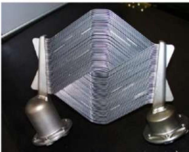
**Figura N° 3.22.** Receptor de tubos iluminados directamente.
