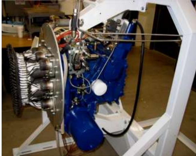
**Figura N° 3.31. Motor Stirling tipo beta. [30]**
