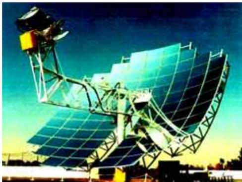
**Figura N° 2.15.** Sistema de Disco Stirling
