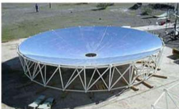
**Figura N° 3.19.** Concentrador de 8'5 metros de diámetro de SBP.
