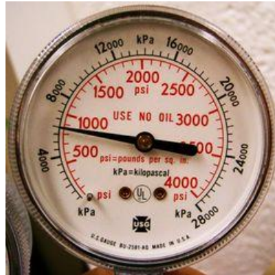
Figura 2.3 Manómetro en escala de kPa y psi.
