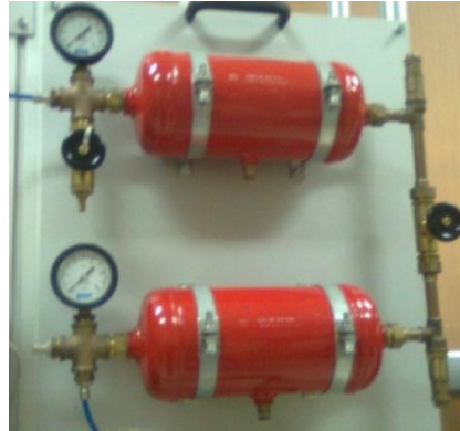
Figura 2.11 Depósitos de presión.
