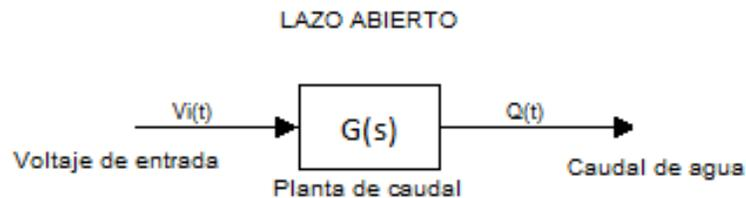
Figura 1.- Esquema de lazo abierto.
