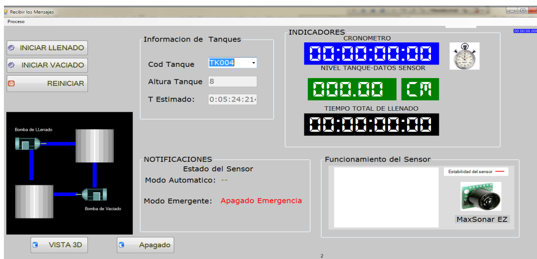
Figura 5.18 Dato erróneo del sensor y ejecución del modo Apagado de Emergencia
