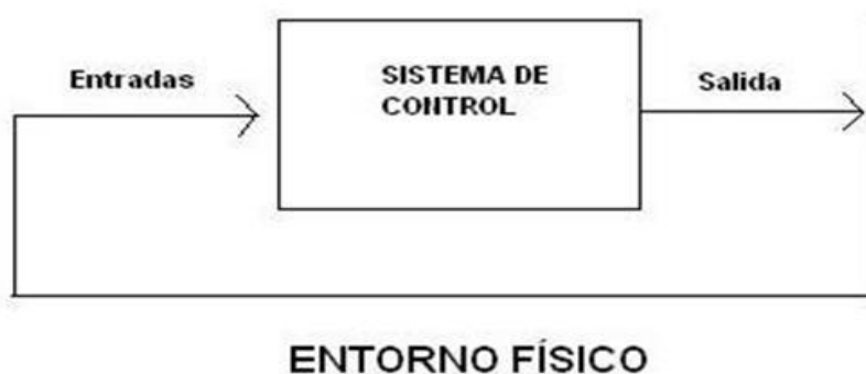
Figura2.13 Entorno físico de sistema de control
