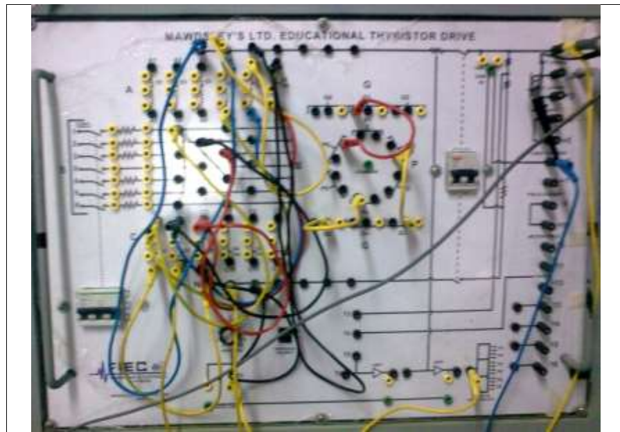
Figura 2.29 Imagen de las conexiones de control y disparo del rectificador trifásico semicontrolado
