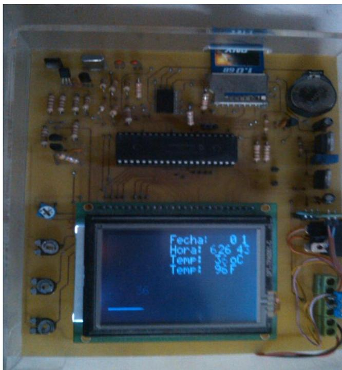
**Figura 21: Fotografía Posterior del Circuito ensamblado.**
