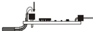
**Figura 11: Conexión de la unión con el módulo DS2760**
