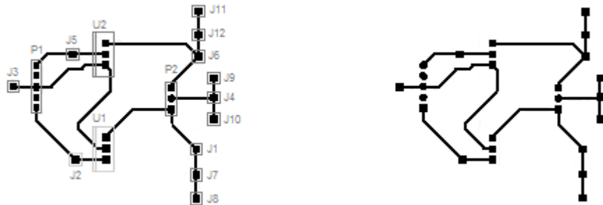
Gráfico 44: Circuito impreso de la tarjeta de alimentación
