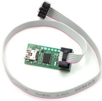
Fig. 2.4.2: Pololu USB AVR Programmer
