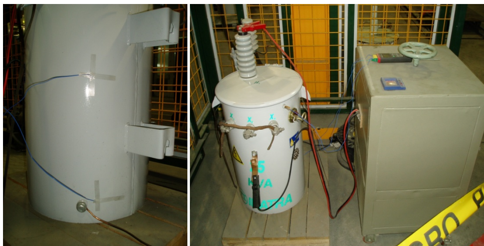
Figura 5.1. Ensayo de calentamiento.
