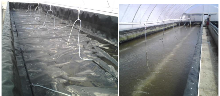
Fig. 2.4 Sistema Raceway al aire libre con tubos de aireación
