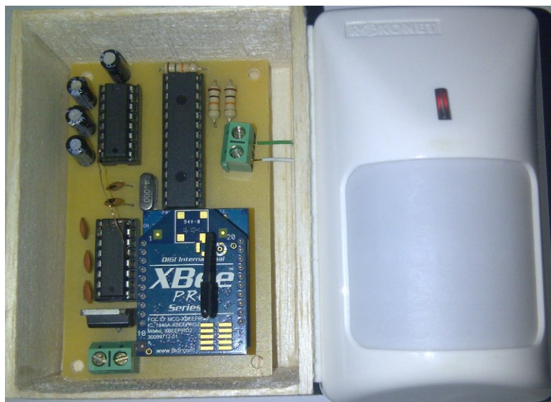
Figura 3-4 Dispositivo electrónico del Bloque Emisor
