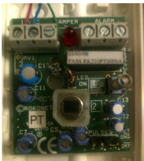
Figura 3-2 Circuito del Sensor de Movimiento
