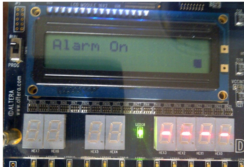
Figura 4-8 Sistema de alarma activado
