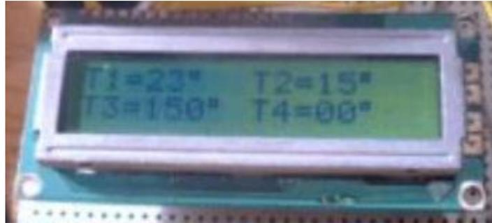
**FIGURA 1.3.-** En el LCD se muestran los 4 canales T1=RA0, T2=RA1, T3=RA2, T4=RA5.
