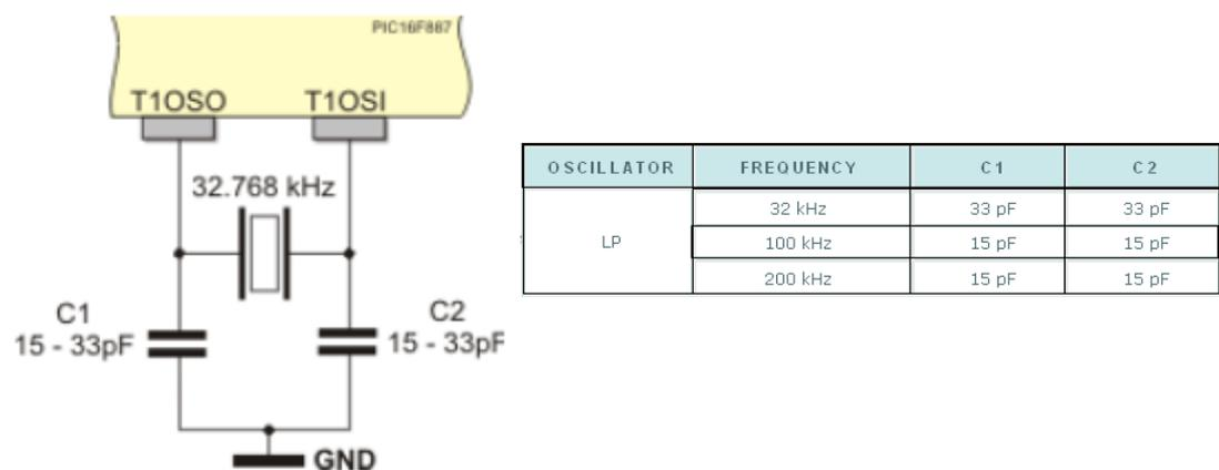
**FIGURA 2.20.- Conexión del Oscilador del TIMER1**
