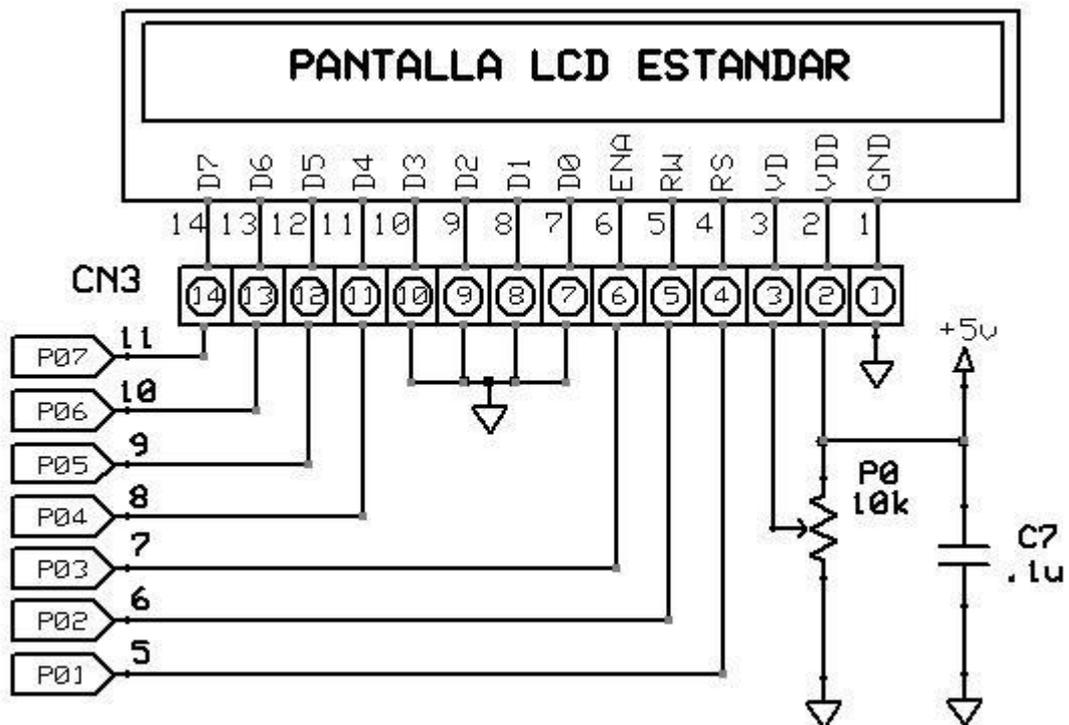
**FIGURA 2.22 .-** Esquema de conexiones de la pantalla LCD.
