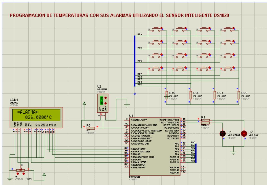
FIGURA 4.5.- Esquema de Conexión del Microcontrolador
