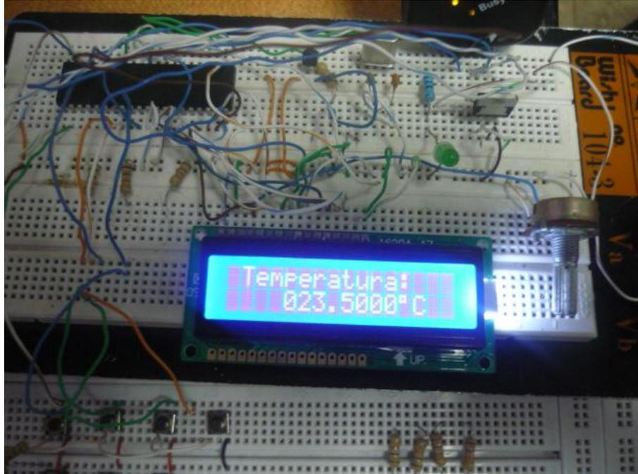
**FIGURA 4.3.- Sistema de Alarma con el Sensor DS1820**
