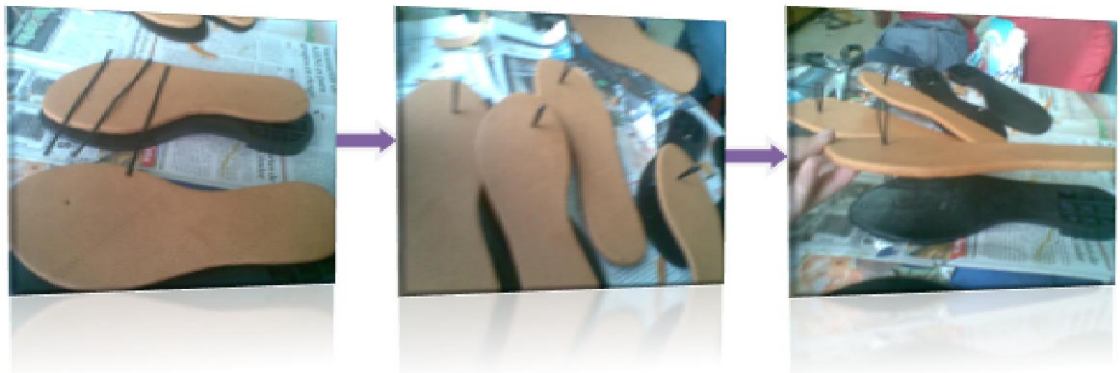
Gráfico N° 3.7 Colocación de tiras superfinas
