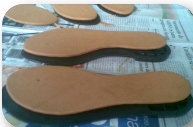
Gráfico N° 3.6 Pegado de plantillas y badana a la suela.
