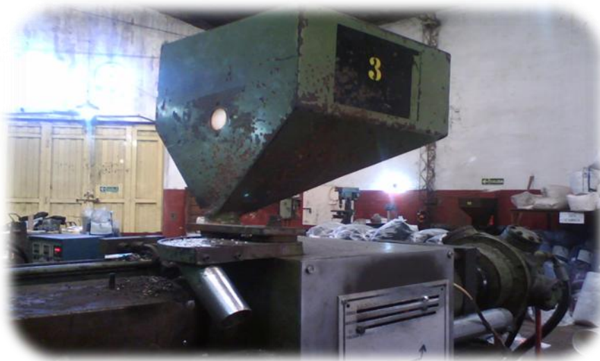
Gráfico N° 3.3 Máquina de inyección para elaboración de suelas
