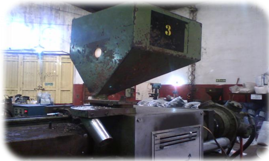
Gráfico N° 3.3 Máquina de inyección para elaboración de suelas
