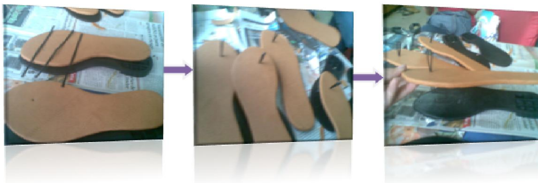
Gráfico N° 3.7 Colocación de tiras superfinas
