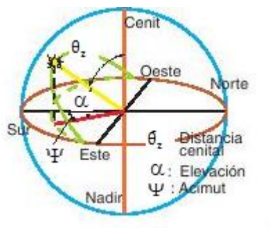
Figura 8.- Acimut y elevación solar
