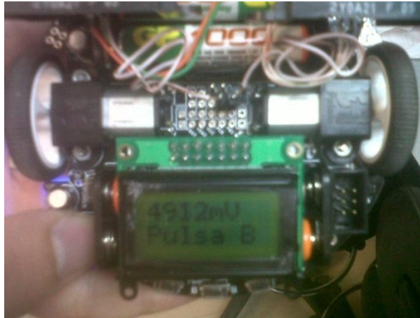
FIGURA 4.8 Nivel actual del voltaje mostrado en la LCD funcionando
