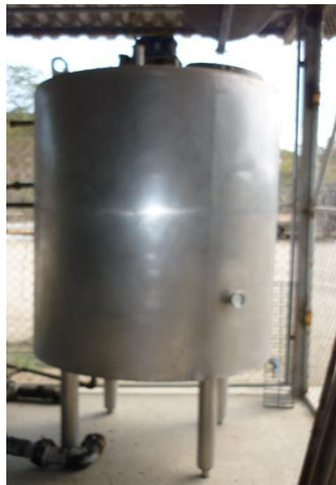
Figura 2.1 B: Tanque enchaquetado No operativo vista lateral
