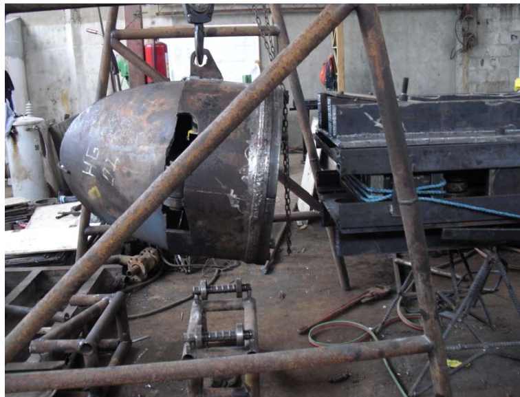
Figura A.17 Ensamblaje de las almejas y su base al cuerpo principal
