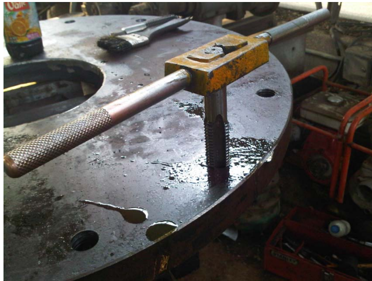
Figura A.11 Machuelo utilizado para roscar
