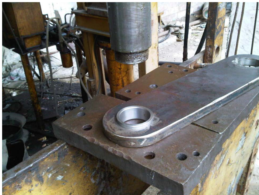
Figura A.14 Los cojinetes de deslizamiento se insertaron con ayuda de una prensa hidráulica
