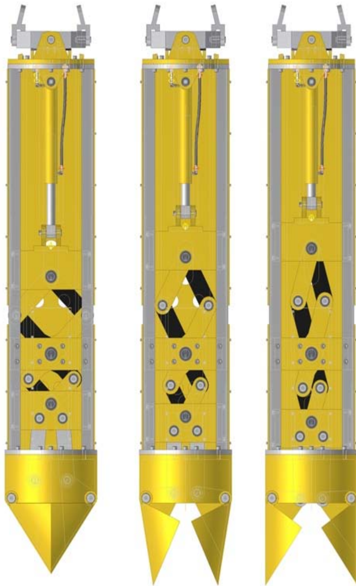
Figura 3.6 Mecanismo en tres posiciones: abierto, cerrado y una posición intermedia
