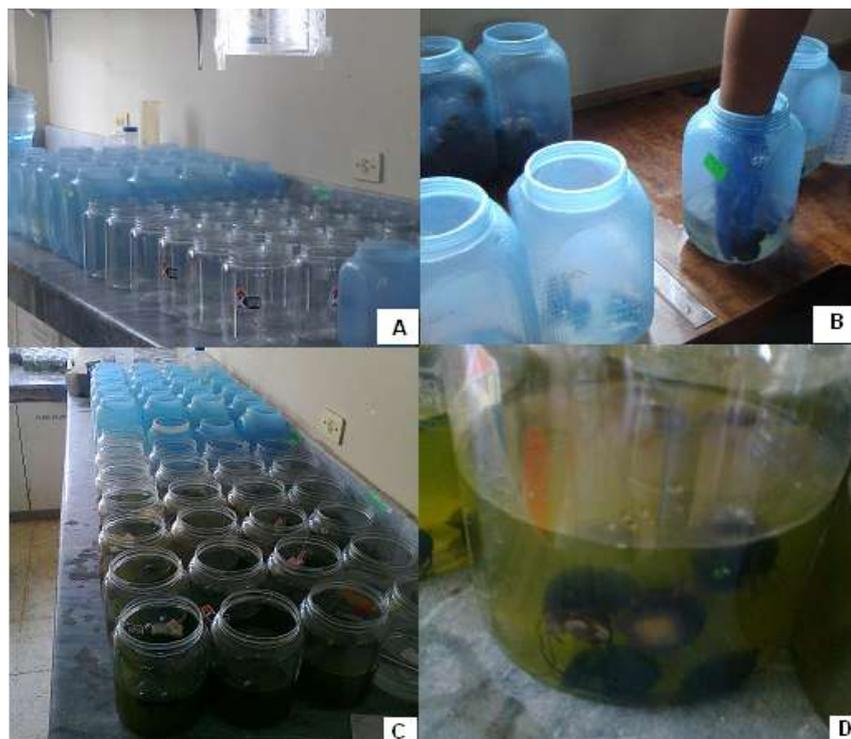
**FIGURA. 2.9 (A) VIALES DE POLIETILENO USADOS PARA EL BIOENSAYO EN EL LABORATORIO. (B) COLOCACIÓN DE DIEZ CARACOLAS POR VIAL. (C) BIOENSAYO EN EL LABORATORIO, VIALES CON LAS DILUCIONES DE EXTRACTOS (D) EXTRACTO DILUIDO EN EL VIAL CON LOS CARACOLAS (*POMÁCEA CANALICULATA*).**
