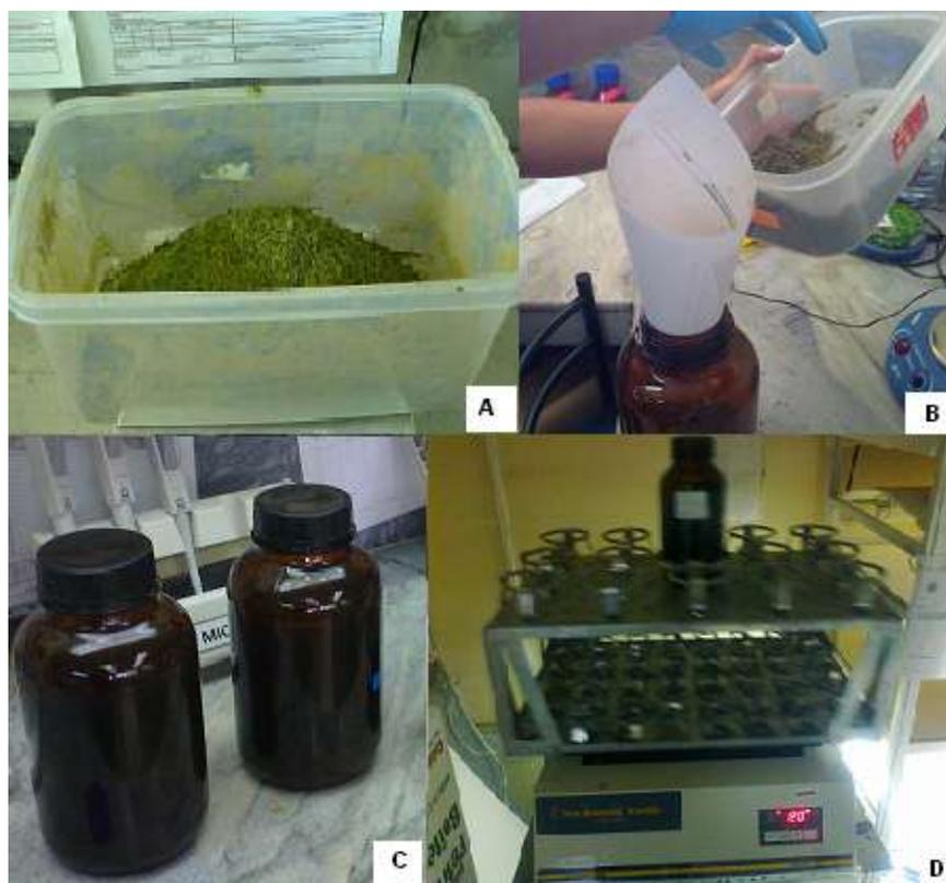
**FIGURA. 2.5 (A) MATERIAL VEGETAL TRITURADO (CBE-PAT-FP-002). (B) COLOCACIÓN DEL MATERIAL EN LOS RECIPIENTES. (C) FRASCOS CON LA MEZCLA (TRITURADO/ALCOHOL ETÍLICO AL 80%). (D) PROCESO DE HOMOGENIZACIÓN DE LA MEZCLA.**
