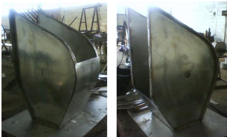
FIGURA 3.6 CUERPO TRITURADOR ARMADO Y REMATADO.
