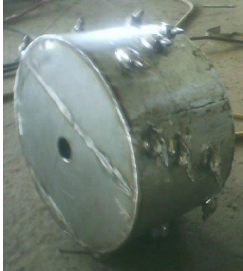
FIGURA 3.15 TAMBOR TRITURADOR ARMADO Y REMATADO
