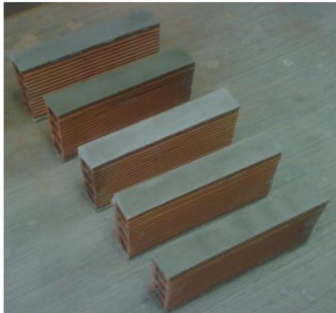
Ilustración 0.17 Colocación de mortero en muestras
