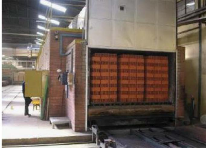
Ilustración 0.7 Horno de secado
