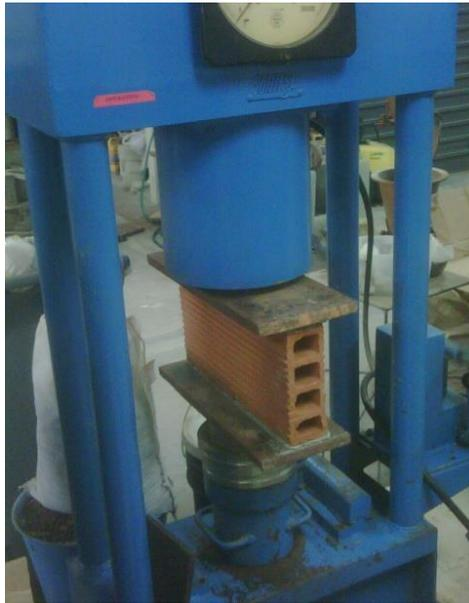
Ilustración 0.18 Ejecución del ensayo de la compresión
