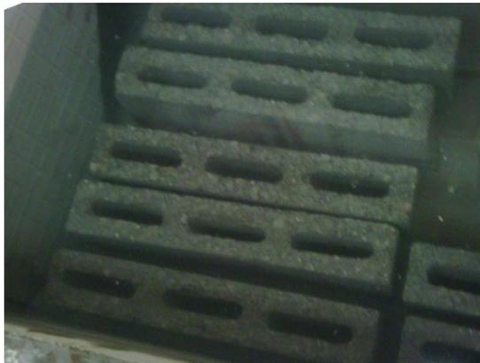
Ilustración 0.9 Hidratación de los bloques de hormigón
