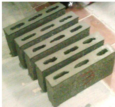
Ilustración 0.4 Muestras con mortero cemento-arena
