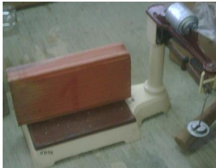
Ilustración 0.19 Pesaje de los bloques de arcilla
