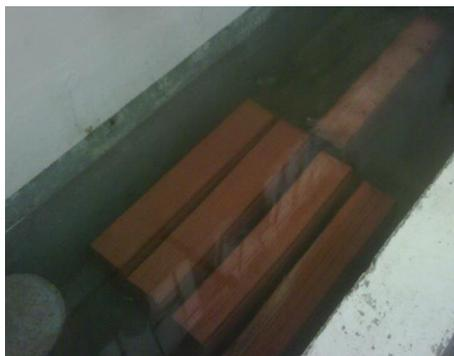
Ilustración 0.20 Hidratación de los bloques de arcilla
