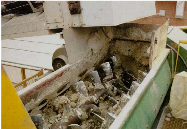
Ilustración 0.4 Mezcla de arcilla con agua
