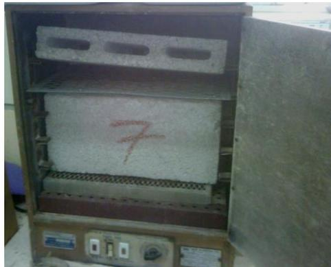
Ilustración 0.12 Bloques de hormigón en horno
