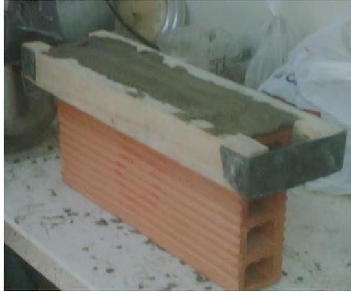
Ilustración 0.16 Colocación de mortero en muestras
