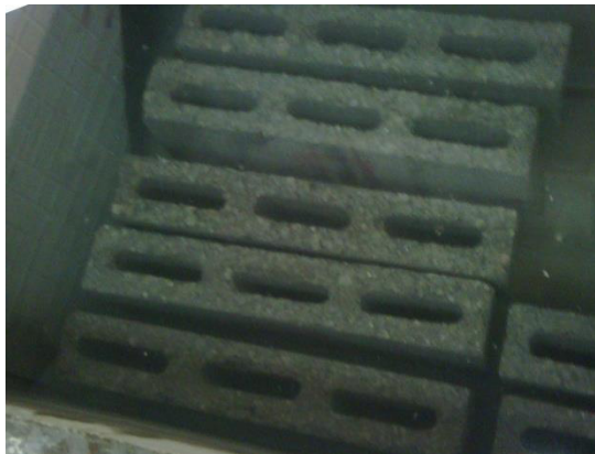
Ilustración 0.9 Hidratación de los bloques de hormigón
