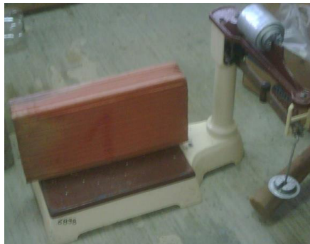
Ilustración 0.19 Pesaje de los bloques de arcilla A temperatura ambiente, se sumergen los especímenes durante 24 horas.
