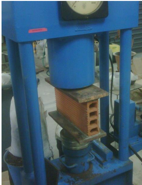
Ilustración 0.18 Ejecución del ensayo de la compresión
