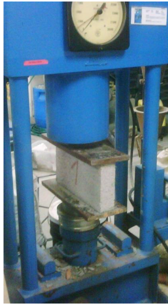
Ilustración 0.6 Ejecución del ensayo de resistencia
