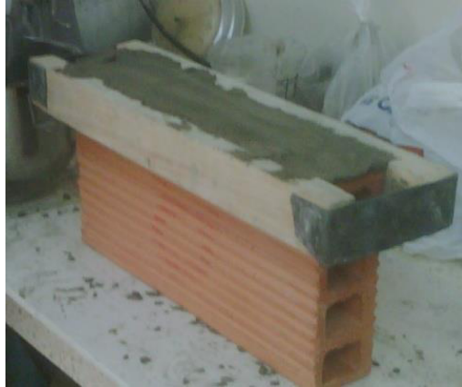
Ilustración 0.16 Colocación de mortero en muestras
