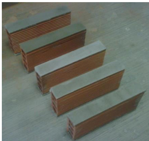
Ilustración 0.17 Colocación de mortero en muestras
