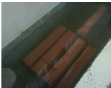
Ilustración 0.20 Hidratación de los bloques de arcilla Se retiran los especímenes húmedos y se los deja drenar sobre la malla gruesa de alambre de 9.5mm durante un minuto aproximadamente, luego el agua superficial visible se quita pasándole un paño ligeramente humedecido e inmediatamente se pesa por separado cada espécimen.
