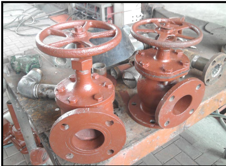
FOTO No. 18 Válvulas de fondo
