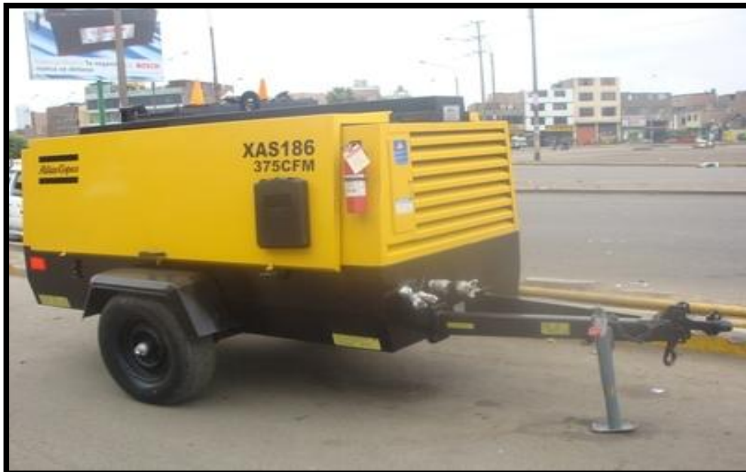
FOTO No. 28 Compresor de aire
