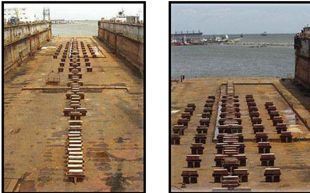
FOTO No. 10 Camas de varamiento
