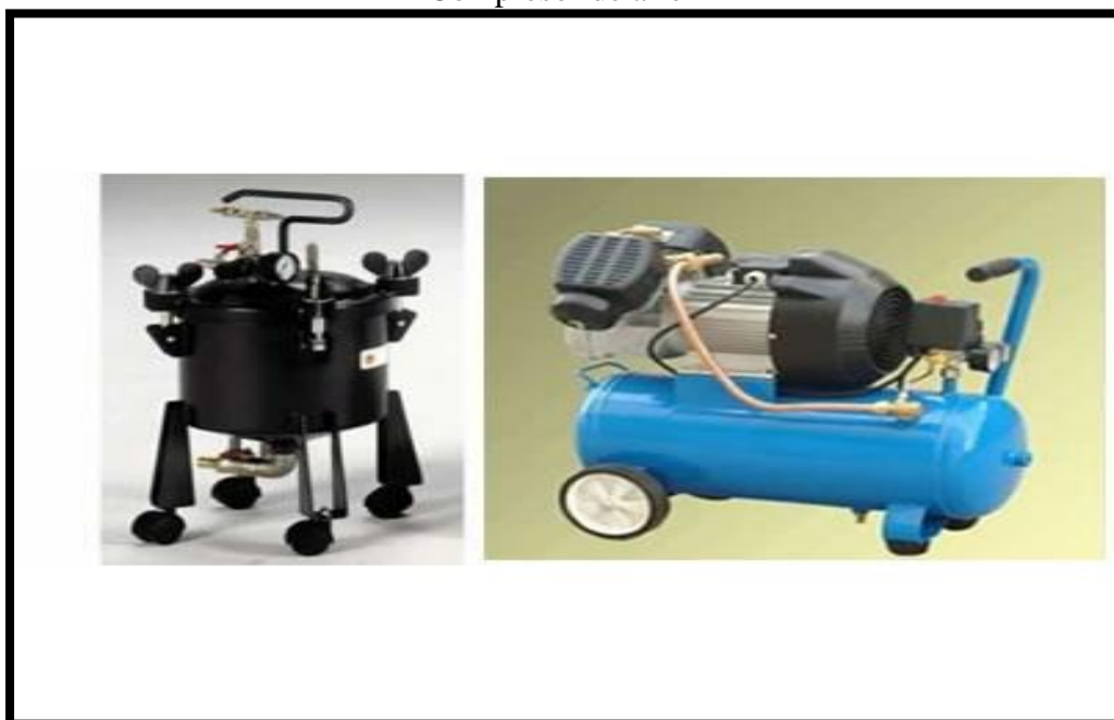
FOTO No. 39 Compresor de aire
