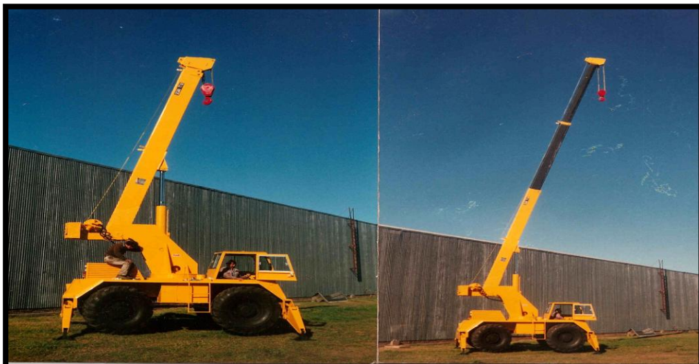
FOTO No. 26 Grúas móviles hidráulicas
