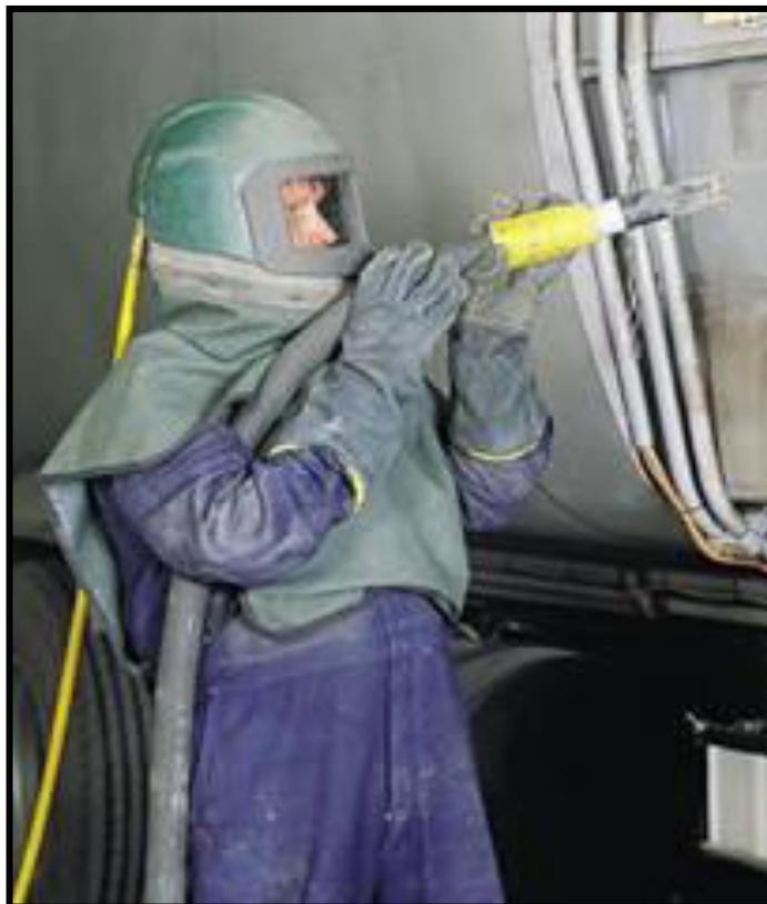
Fuente: P & H, sección materiales de compresores (protección para el sandblasting)
