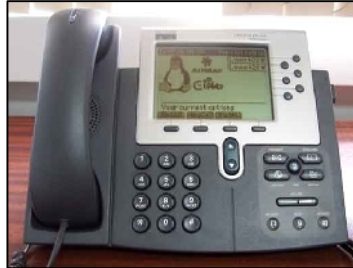
Figura 1.5.1 (a) - Teléfono IP [REF.6]
