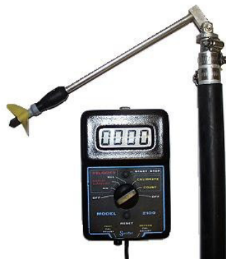
Figura No. 57 Medidor de Velocidad Swoffer, Modelo 2100
