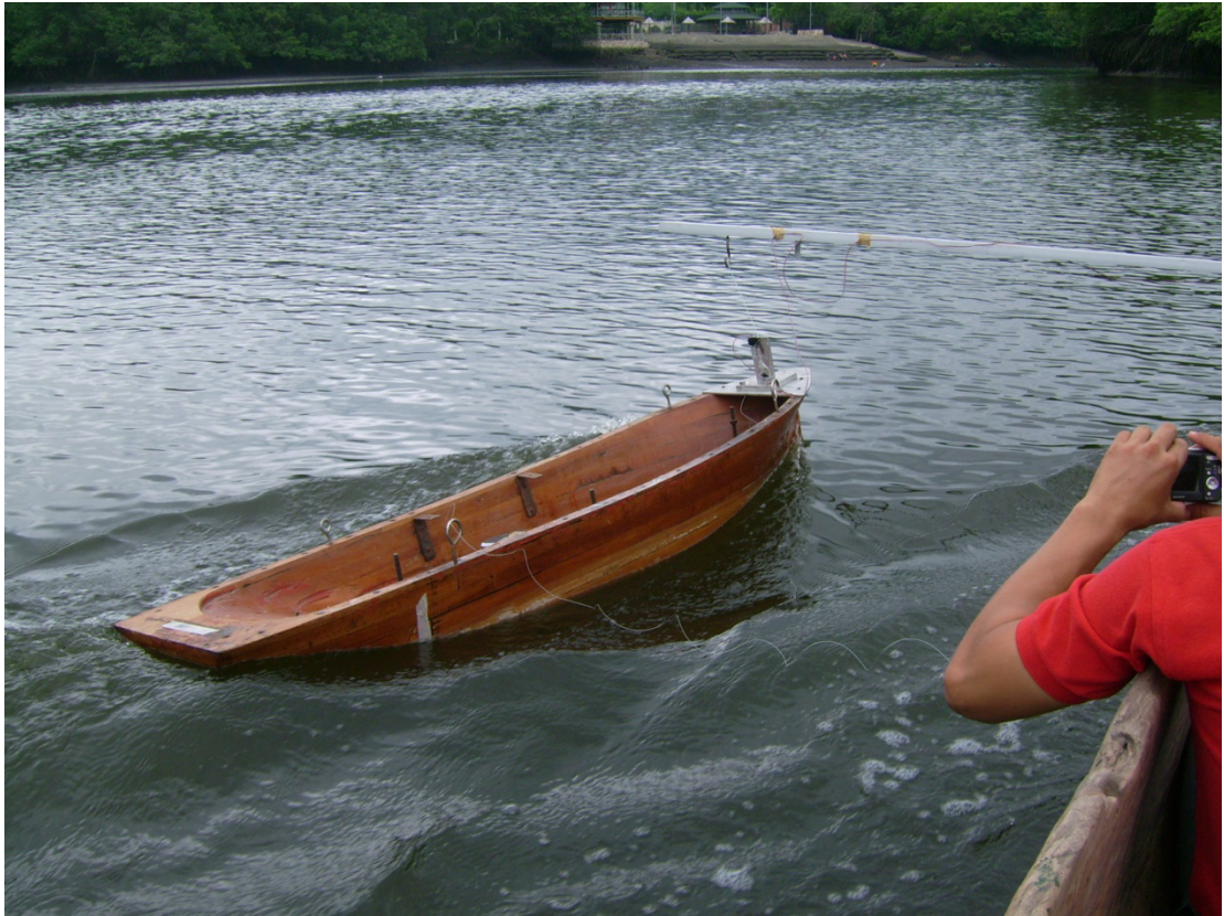
Figura No. 50 Pruebas Preliminares con Brazo de Arrastre de 2 m de Longitud
