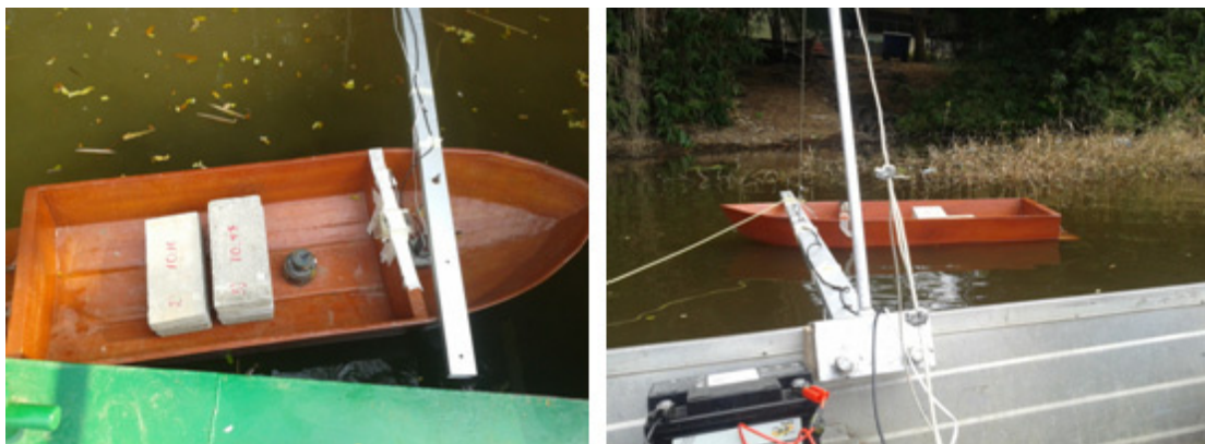
Figura No. 47 Modelo con Condición de Carga 2, 91.9 kg
