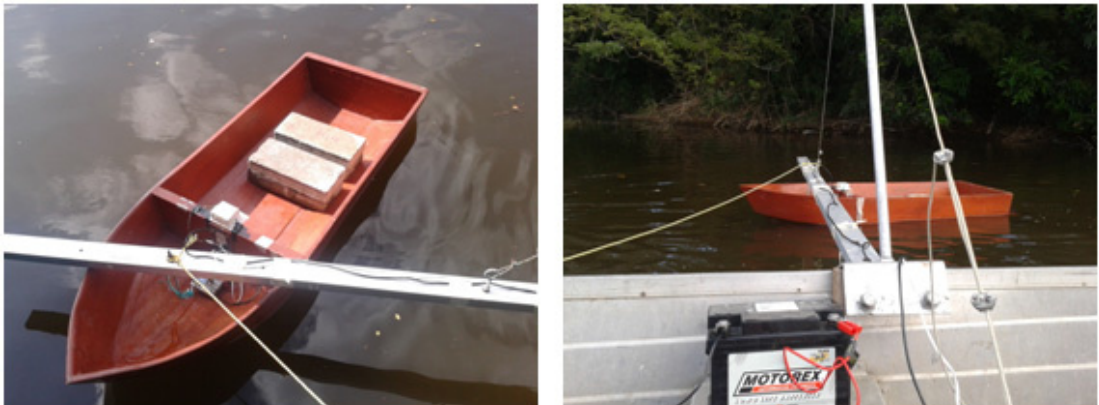
Figura No. 46 Modelo con Condición de Carga 1, 71.1 kg
