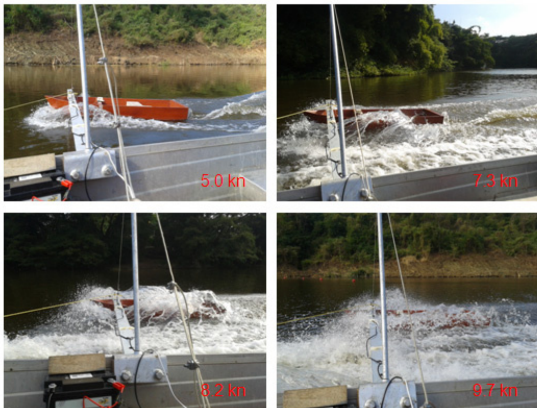
Figura No. 26 Prueba Experimental con el Modelo con Flaps a 10^\circ en Condición de Carga 2
