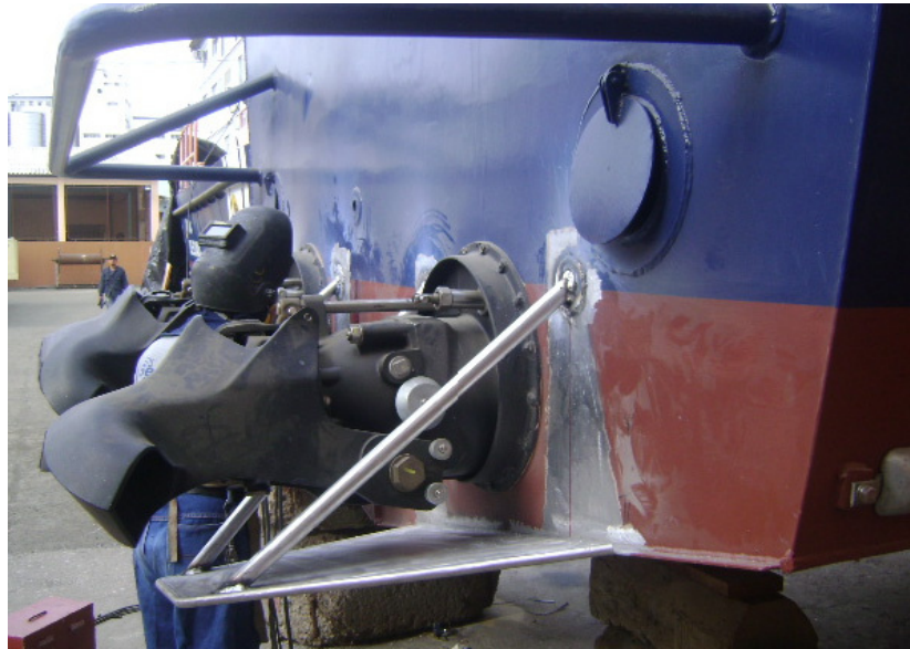
Figura No. 4 Flaps montados en Lancha Prototipo, [6]
