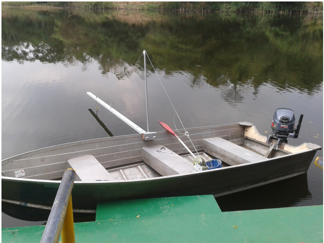
Figura No. 51 Brazo de Arrastre de 3.2 m acoplado a Lancha de Aluminio
