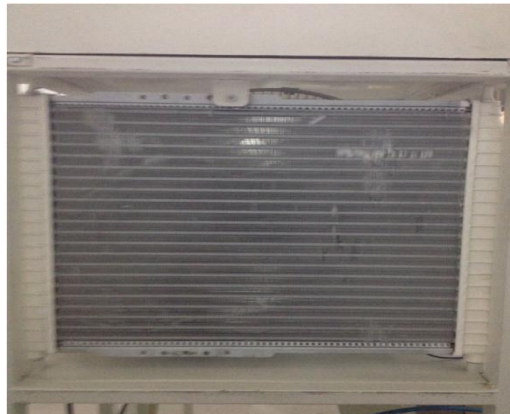
Figura 3.3 Intercambiador de calor.
