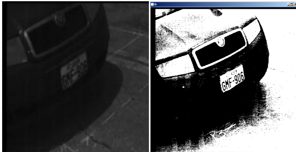
a) Imagen original de placa b) imagen de placa umbralizada.
