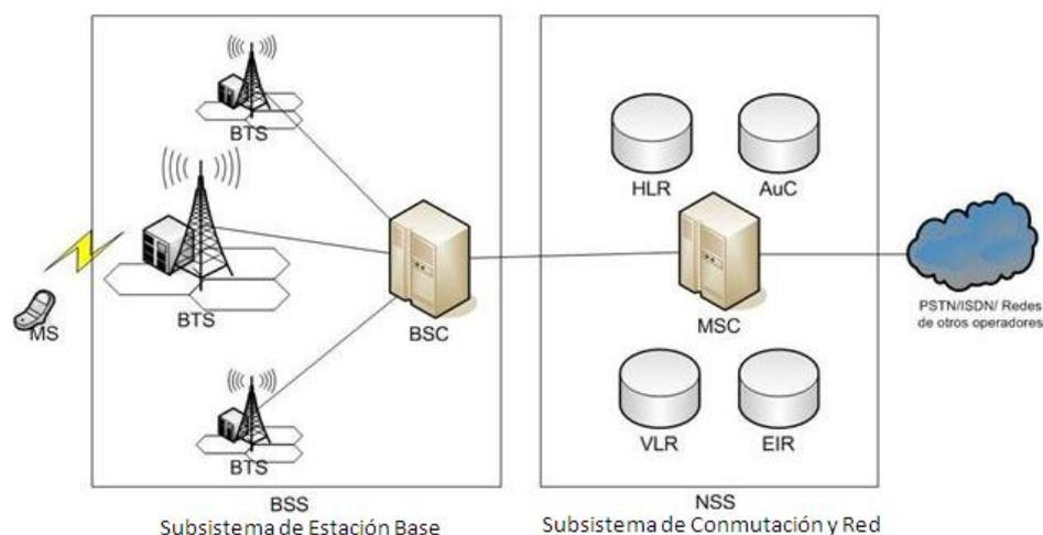
**Figura 2-7 Arquitectura de una Red GSM [4]**
