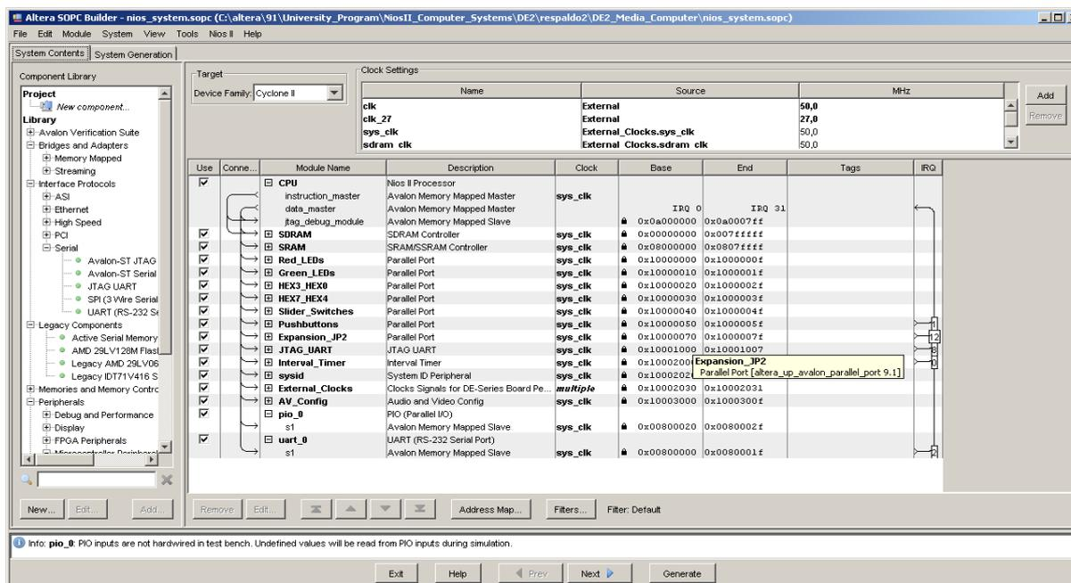
Figura 3-3 Diseño del sistema en SOPC Builder
