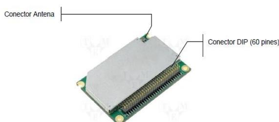
**Figura 3-11 Módulo GSM [9]**
