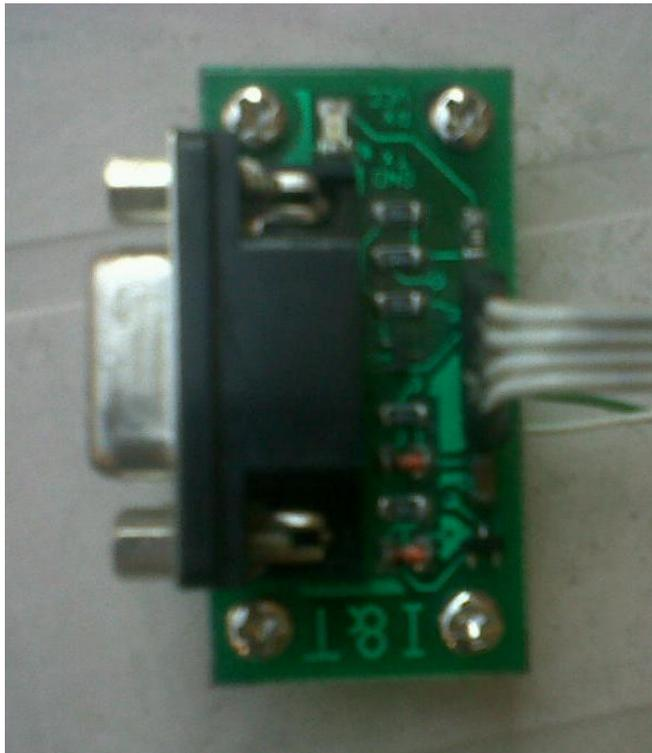
**Figura 3-9 Convertidor de Voltajes**
