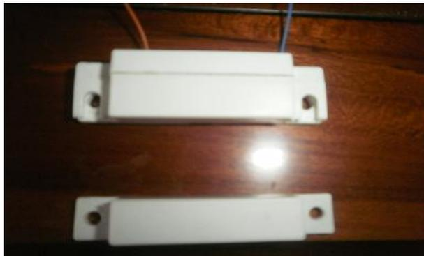
**Figura 4-4 Switch Magnético abierto**
