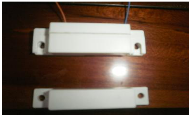
Figura 4-4 Switch Magnético abierto
