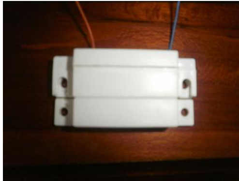
Figura 4-3 Switch Magnético cerrado
