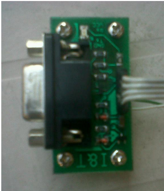
Figura 3-9 Convertidor de Voltajes
