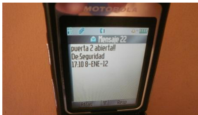
Figura 4-10 Mensaje del Switch 2 en el celular
