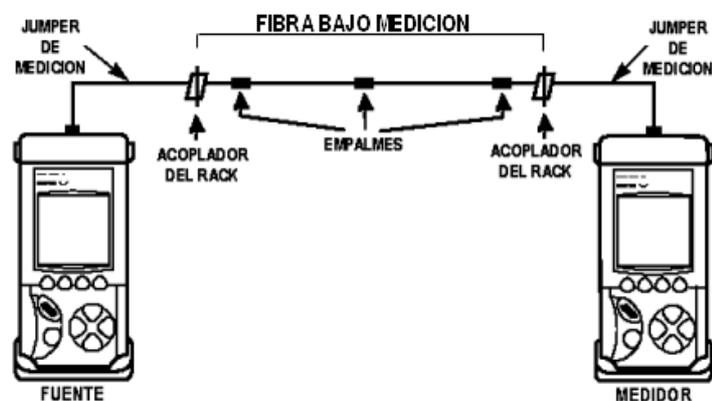
**Figura. 1.23** Tramo a medir con equipos OTDR
