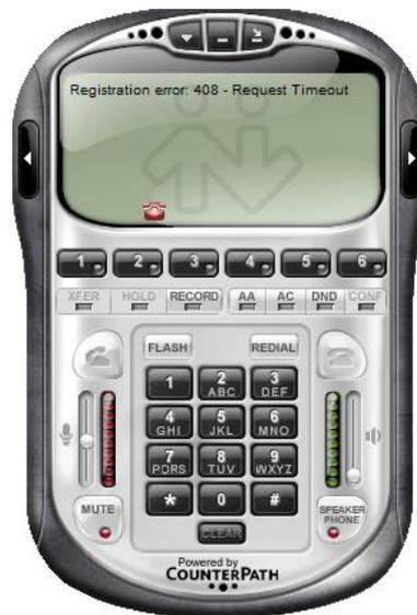
**Figura 4- 19.** Error de registro de cliente SIP debido a asterisk detenido.
