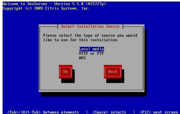
Ilustración 84. Origen de la instalación
