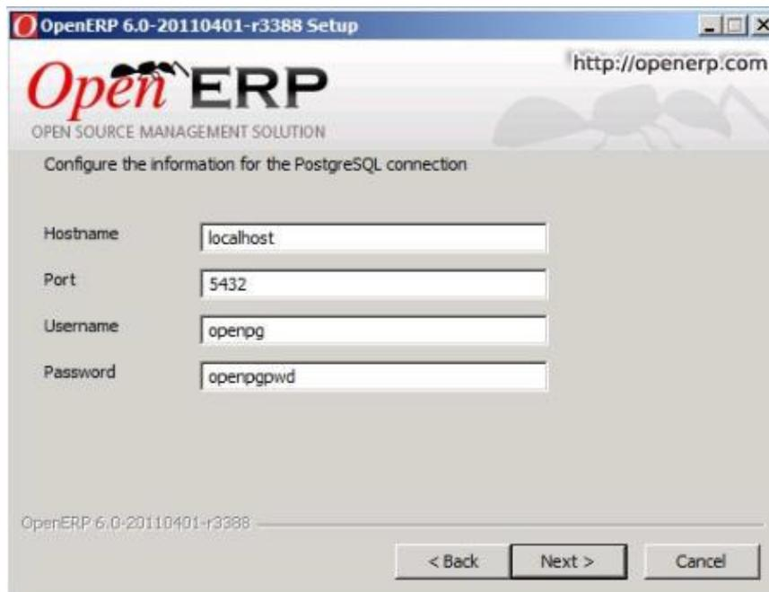
**Figura 37:** Información para conexión con la Base de Datos
