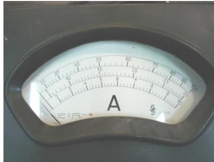
Figura 11. Escala de medición de un amperímetro.
