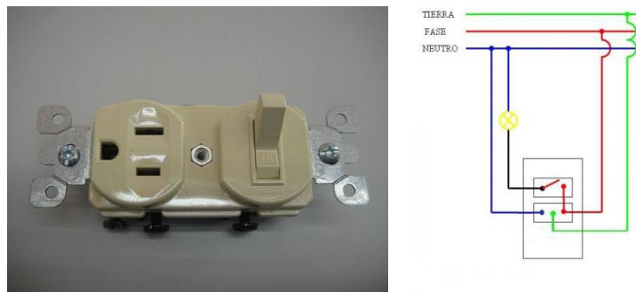
Figura 64. Combinación de interruptor, tomacorriente.
