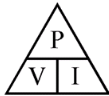
Figura 16. Triángulo de la Ley de Potencia.
