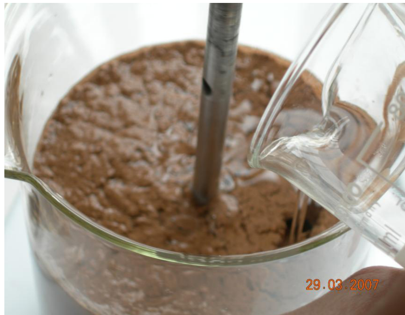
Fig. 4.10 Muestra de lodo con regulador de pH, Coagulante y floculante siendo adicionado, Cristina Ballesteros, abr/ 07
