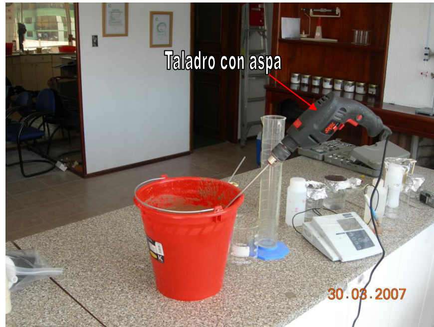
Fig. 4.21 Agitación del lodo Floculado, Cristina Ballesteros, abril 2007
