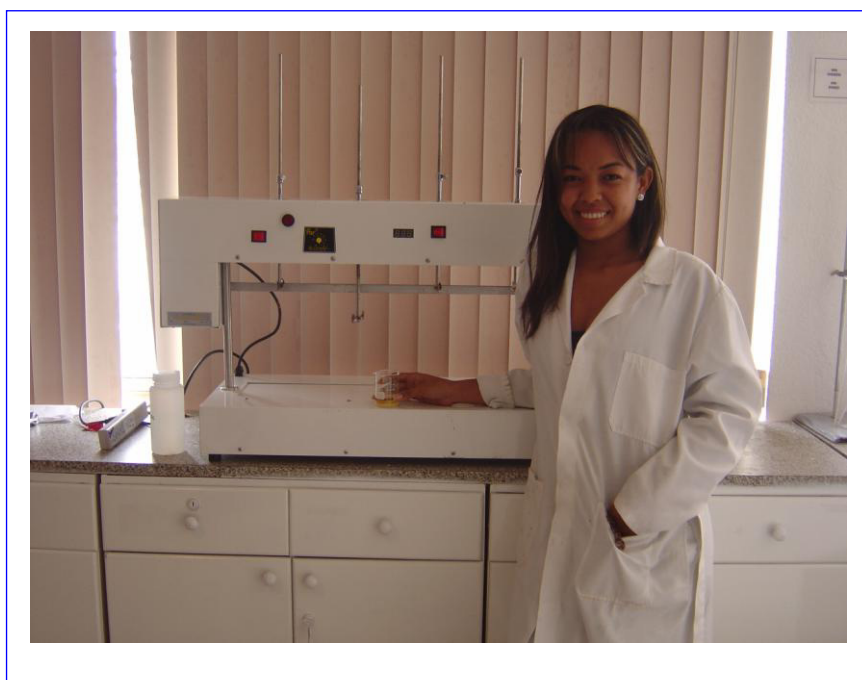
Fig. 4.3 Equipo Jar Test o Equipo de Jarras, Cristina Ballesteros, Abril 2007
