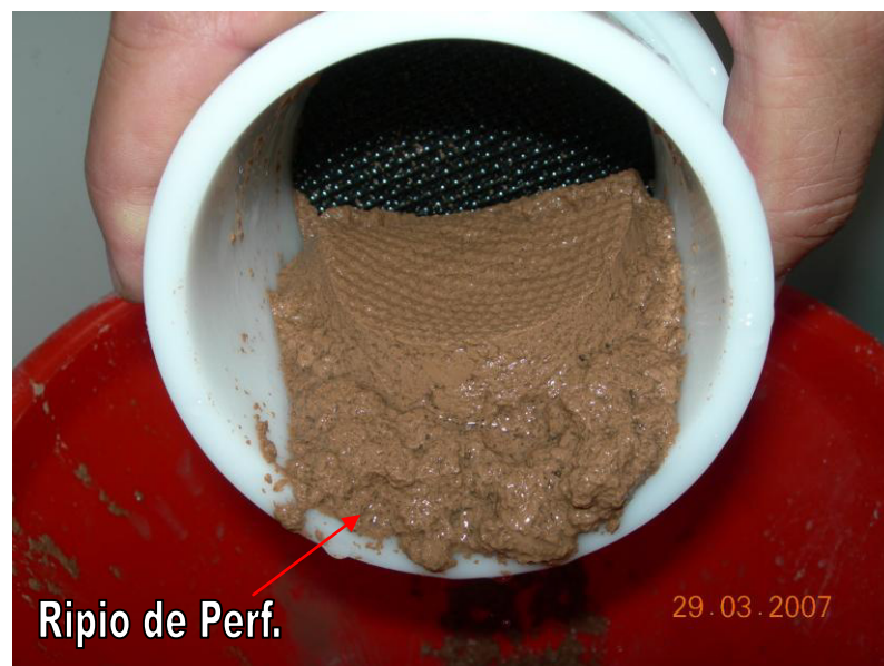
Fig. 4.16 Muestra de lodo acondicionada vaceada del Vaso-Geotubo de Prueba una vez que drene el lixiviado, Cristina Ballesteros, abr/ 07
