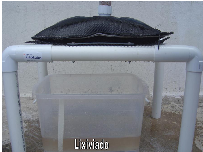
Fig.4.25 Drenaje del Lixiviado, Cristina Ballesteros, abril 2007
