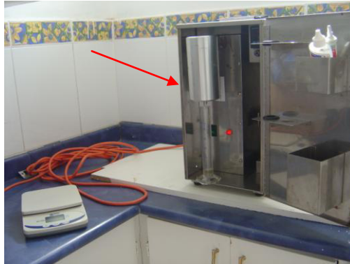
Fig.1.1 Instrumento de la Retorta, Cristina Ballesteros., Abril 2007.
