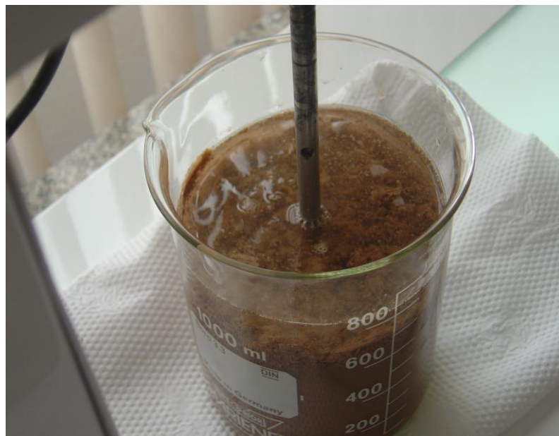
Fig. 4.12 Muestra de lodo con los floculos sedimentados, Cristina Ballesteros, abr/ 07
