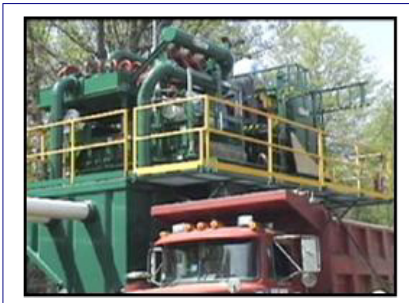
Fig.1.16 Limpiador de Lodo, fuente: Internet, mayo 2007
