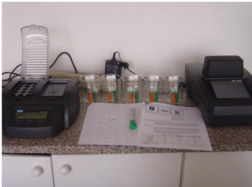
Fig.4.32 Determinación de DQO (Demanda Química de Oxígeno) con el Equipo HATCH, Cristina Ballesteros, abril 2007
