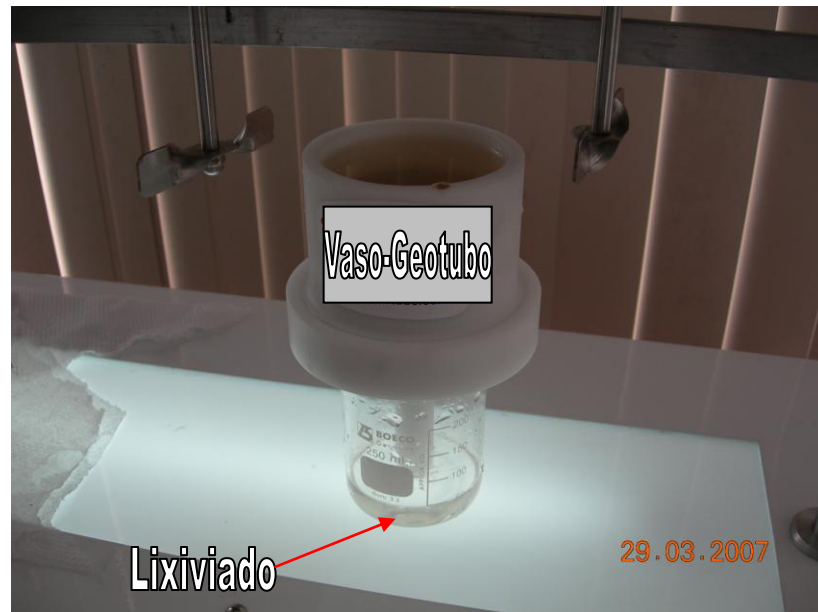
Fig. 4.15 Muestra de lodo acondicionada vaceada en el Vaso-Geotubo de Prueba, Cristina Ballesteros, abr/ 07
