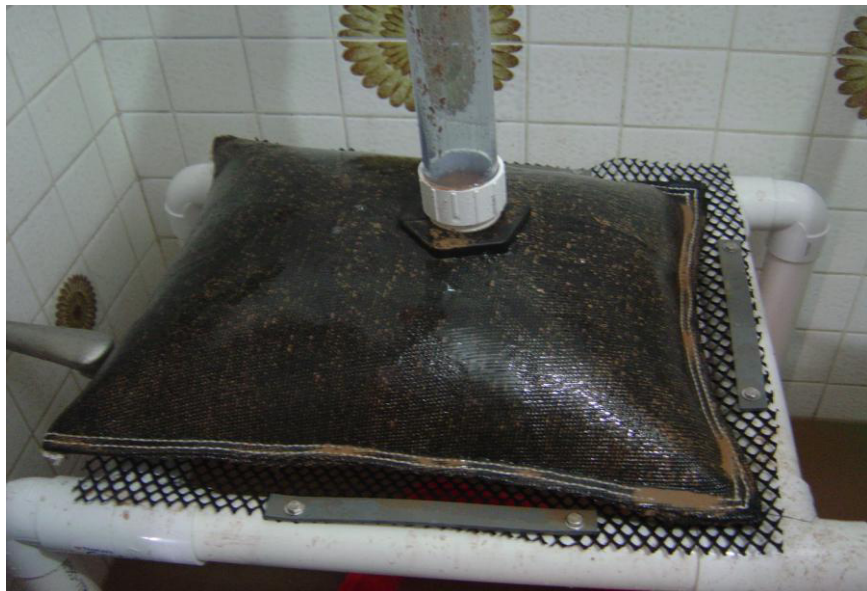
Fig. 4.24 Lodo Acondicionado vaceado en la Bolsa, Cristina Ballesteros, abril 2007
