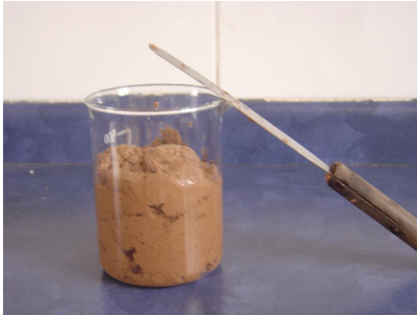
Fig.4.29 Ripio salido del geotubo a los 6 días (lucen más húmedo que en la gráfica anterior), Cristina Ballesteros, abril 2007
