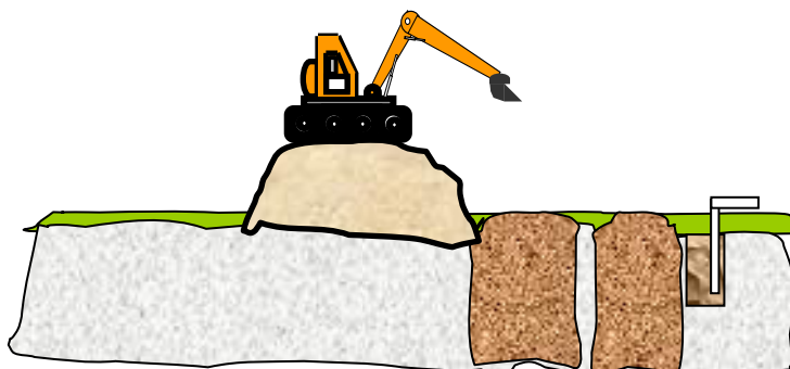
Fig. 3.1. Área de disposición de cortes por celdas, fuente paper "Fijación de Cortes" de Qmax Ecuador SA, proporcionado en Octubre del 2006
