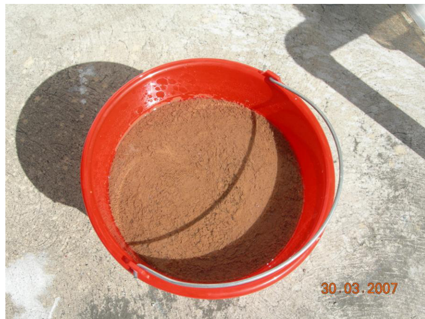
Fig. 4.22 Lodo Floculado, Cristina Ballesteros, abril 2007
