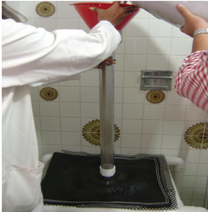
Fig. 4.23 Proceso de Vaceado del lodo acondicionado a la Bolsa GDT, Cristina Ballesteros, abril 2007
