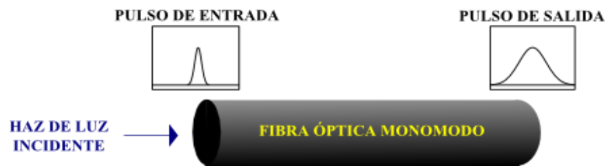
Figura 1. 11 Dispersión cromática en la fibra óptica
