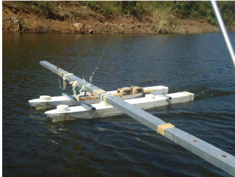
Figura No. 20 Arrastre del Catamarán en Condición Cargada.
