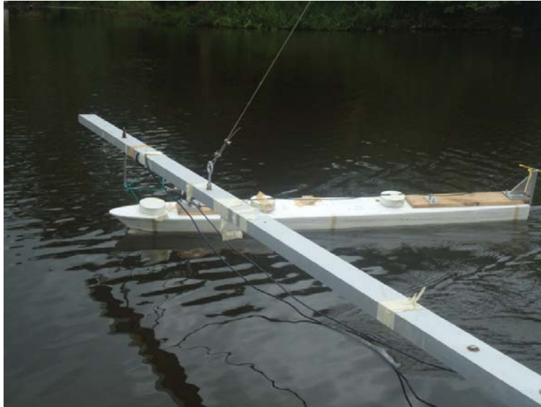
Figura No. 16 Arrastre del Semicasco en Condición Ligera.
