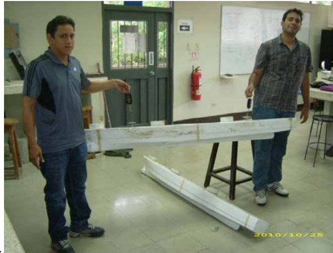
Figura No. 15 Determinación del Peso y LCG del Modelo Ligero Utilizado para las Pruebas.
