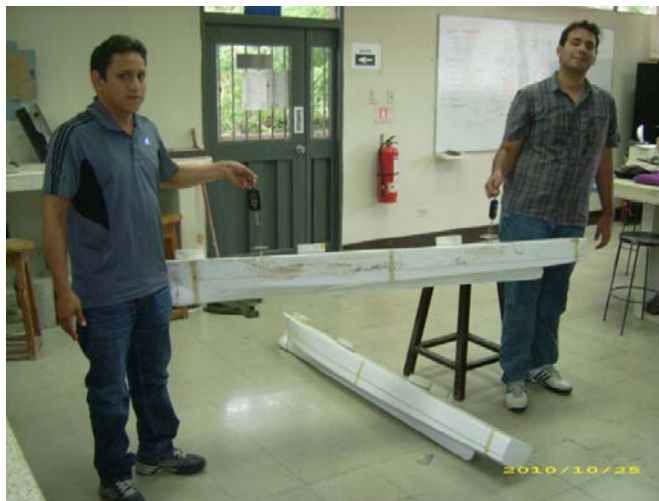
Figura No. 15 Determinación del Peso y LCG del Modelo Ligero Utilizado para las Pruebas.
