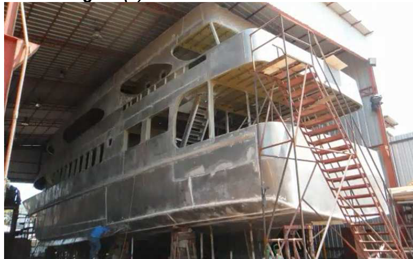
Figura (a) Construcción en Aluminio
